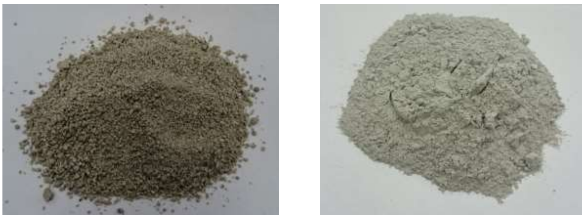
Рис.1. Внешний вид доменного граншлака до и после измельчения.
