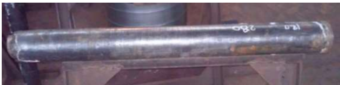
Рис.1. Биметаллическая труба 37Г2Ф–08Х18Н10Т длиной 1 м.
