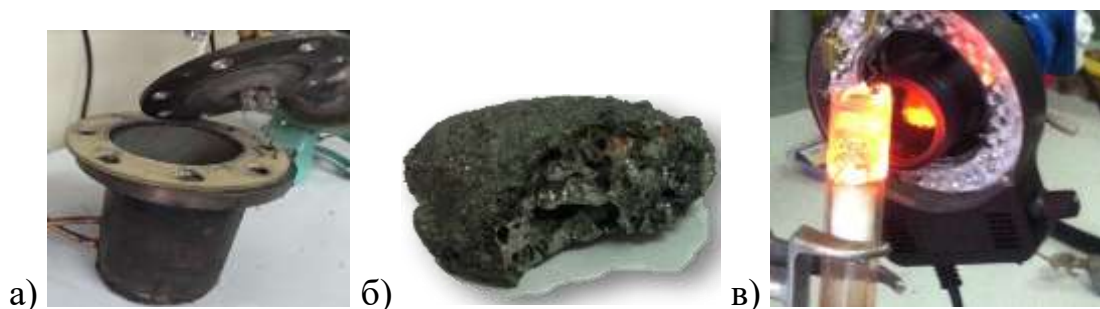
Рис.1. а) Реактор с контролируемой атмосферой (РКА); б) Целевой продукт, синтезированный в РКА; в)
