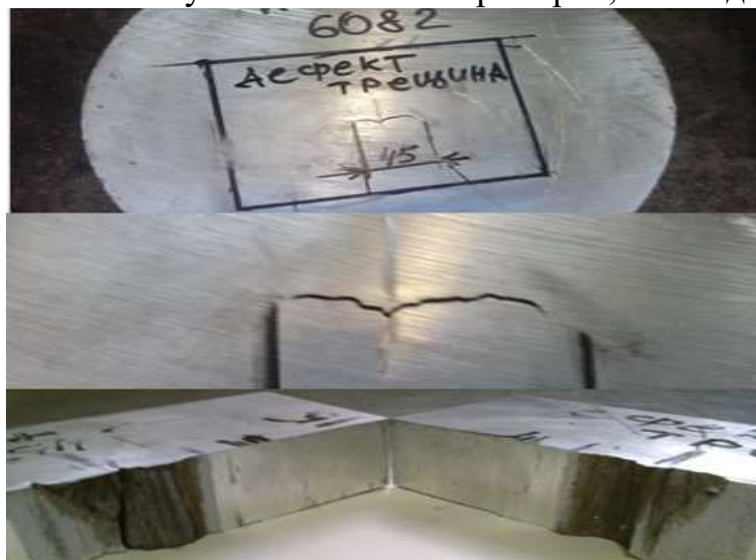
Рис.2. Дефект типа трещина до и после разлома исследованного прутка.
