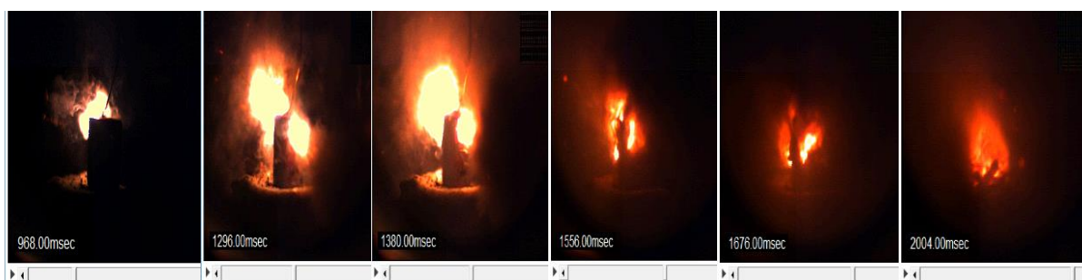
(AN/MgAl, 3 МПа, время горения – 824 мсек, h = 8,58 мм)
