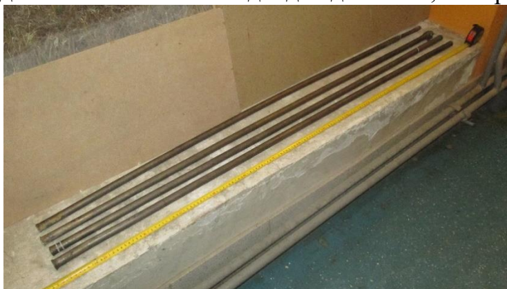
Рис.2. Медно-титановые токоподводы после термообработки и правки на прессе.
