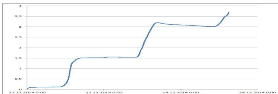
Рис.3. Зарядка конденсатора в течение трёх подмосковных сумеречных декабрьских дней. Для работы пульта необходимо не менее 2,2 В.
