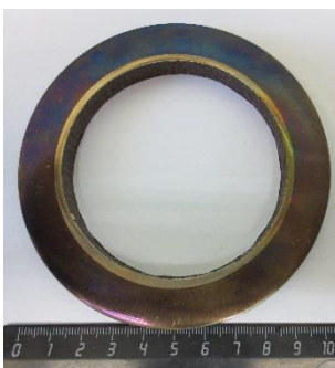
Рис.2. Кольцевой образец 37Г2Ф+08Х18Н10Т, вырезанный из двухслойной трубной заготовки, полученной сваркой взрывом.
