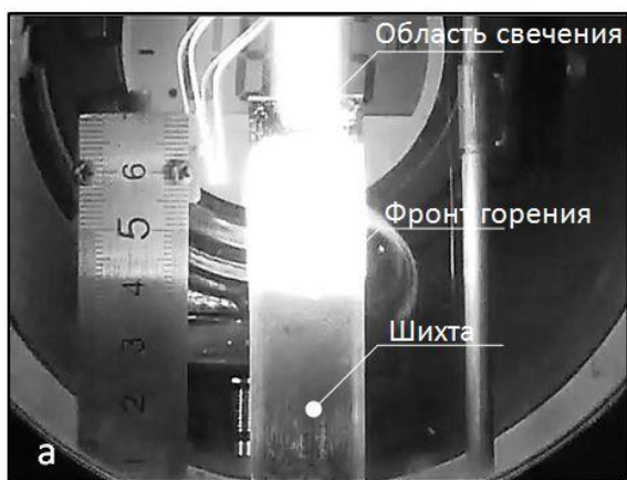
Рис.2. Типичная фотография процесса горения смеси (на примере состава Ti+1.25B горящего в потоке аргона) (а) и зависимость скорости горения от состава смеси, для различных условий проведения экспериментов (б). На рисунке 2(б) цифрами обозначены: кривые 1, 3 – при продуве, 2, 4 – без продува; 1,2 – использование титана, прошедшего ТВО.
