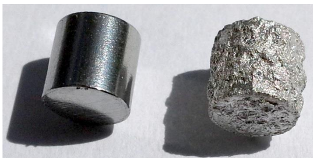
Рис.1. Пример образцов до и после активации, система Mo-(Ti+Al).
